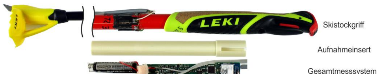
Abb. 1. Skistockgriff mit applizierten DMS am Skistock und Verbindungskabel zur Energieversorgung und Übertragung von Messdaten (oben), Aufnahmeinsert (mittig) und Gesamtmesssystem mit Li-Ion-Akku und Kabeln (unten).
