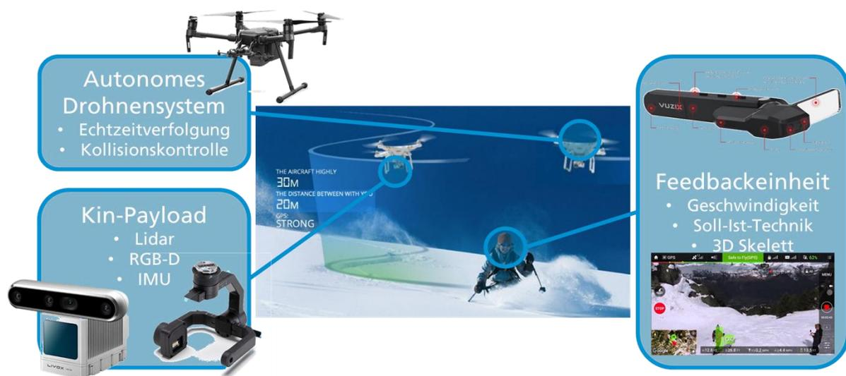
Abbildung 1: Konzept Echtzeit-Drohnen-Feedback System (Fraunhofer IFF)
