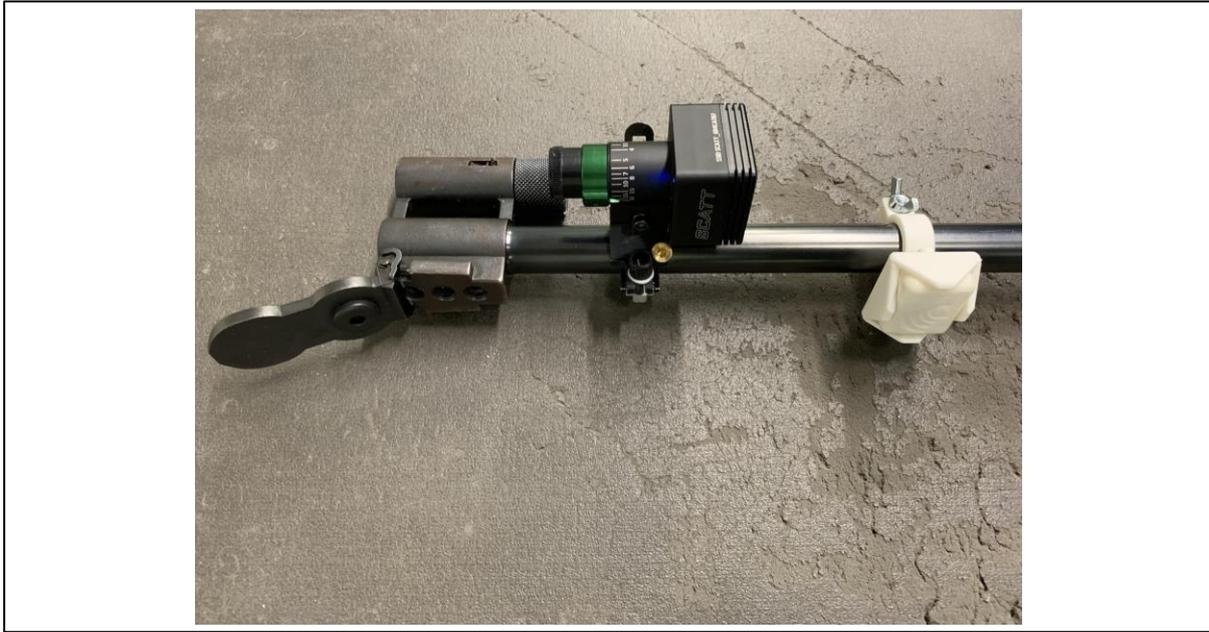
Abb. 2. NilsPod IMU-Sensor (Portables GmbH, Erlangen, Deutschland) am Gewehrlauf, parallel zu einem Scatt MX-W2 (SCATT Electronics LLC, Moskau, Russland)
