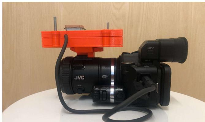
Abbildung 1: Messeinheit (orange) montiert auf dem Blitzschuh der Kamera. Der Zeitstempel wird über das Audiokabel auf die Audiospur der Kamera aufgespielt.
