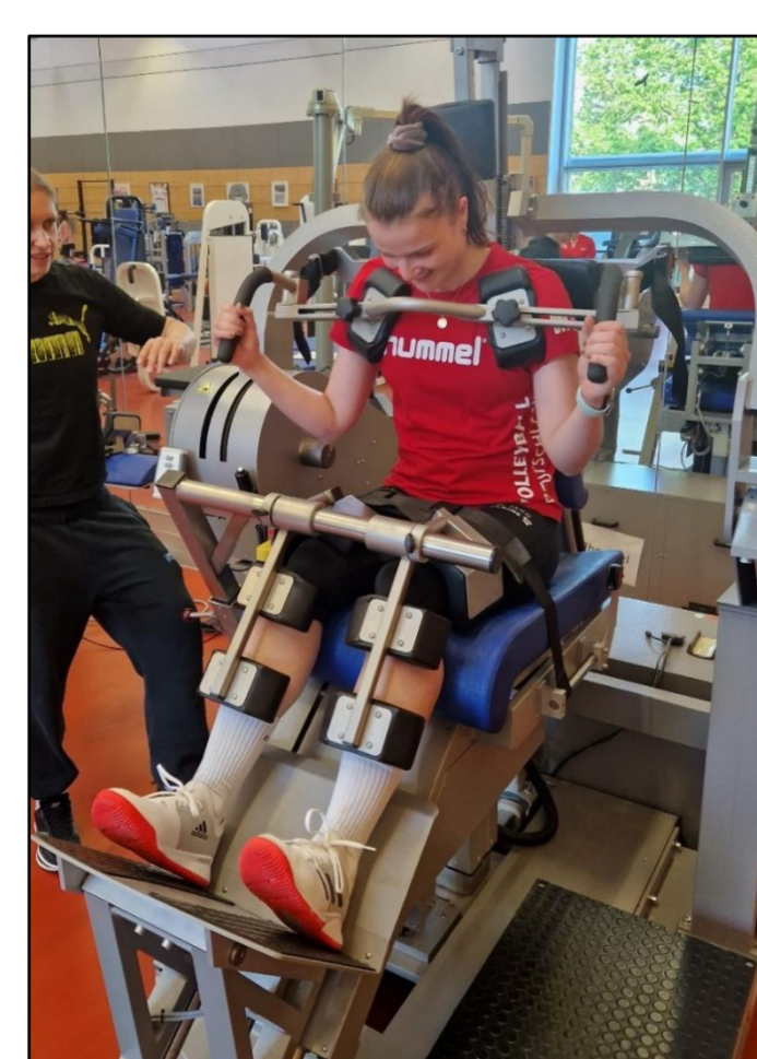
Fig. 2 Isokinetische Maximalkraftmessung IsoMed 2000
